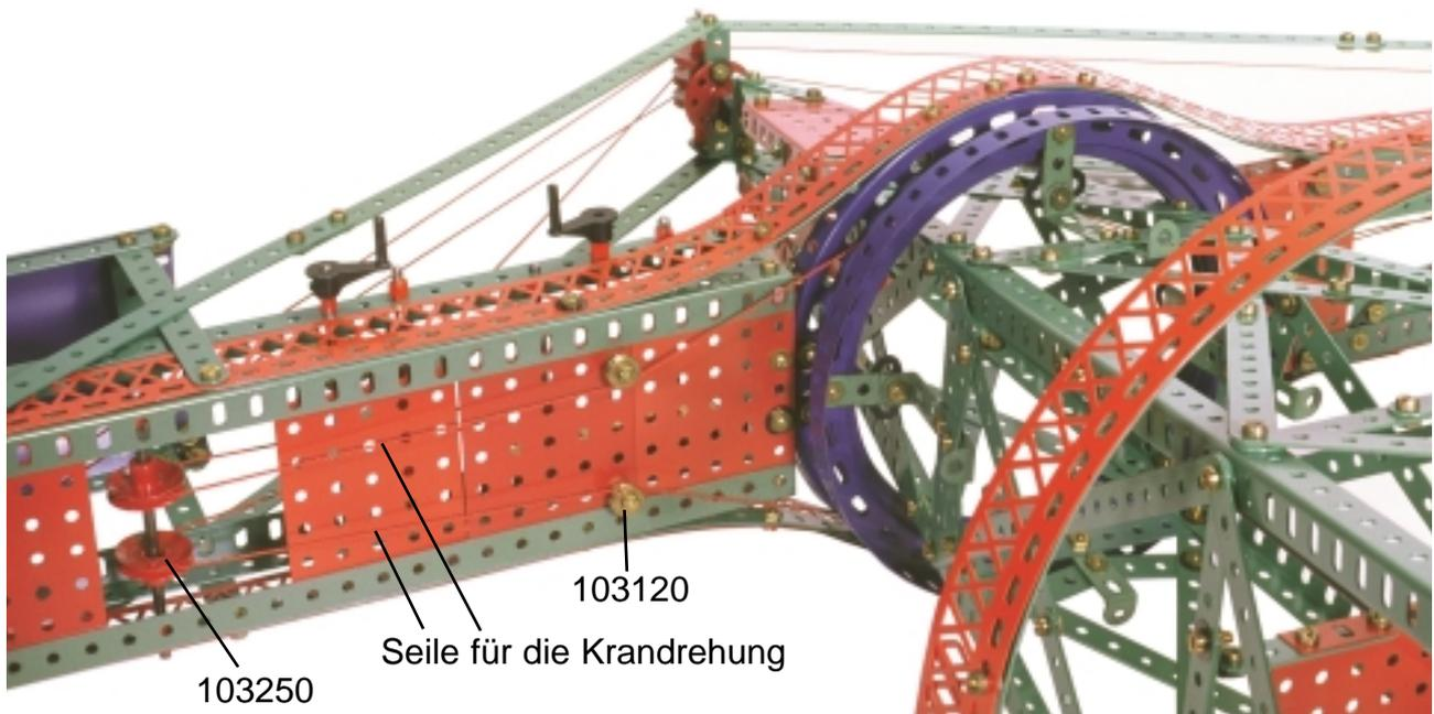
Das Ritzel 10720 lösen und auf der Welle verschieben, dann können die beiden Zahnräder 104570 gegeneinander gedreht und damit das Seil zum Drehen des Auslegers gespannt werden. Dann das Ritzel wieder zwischen die Zahnräder schieben und festschrauben.
